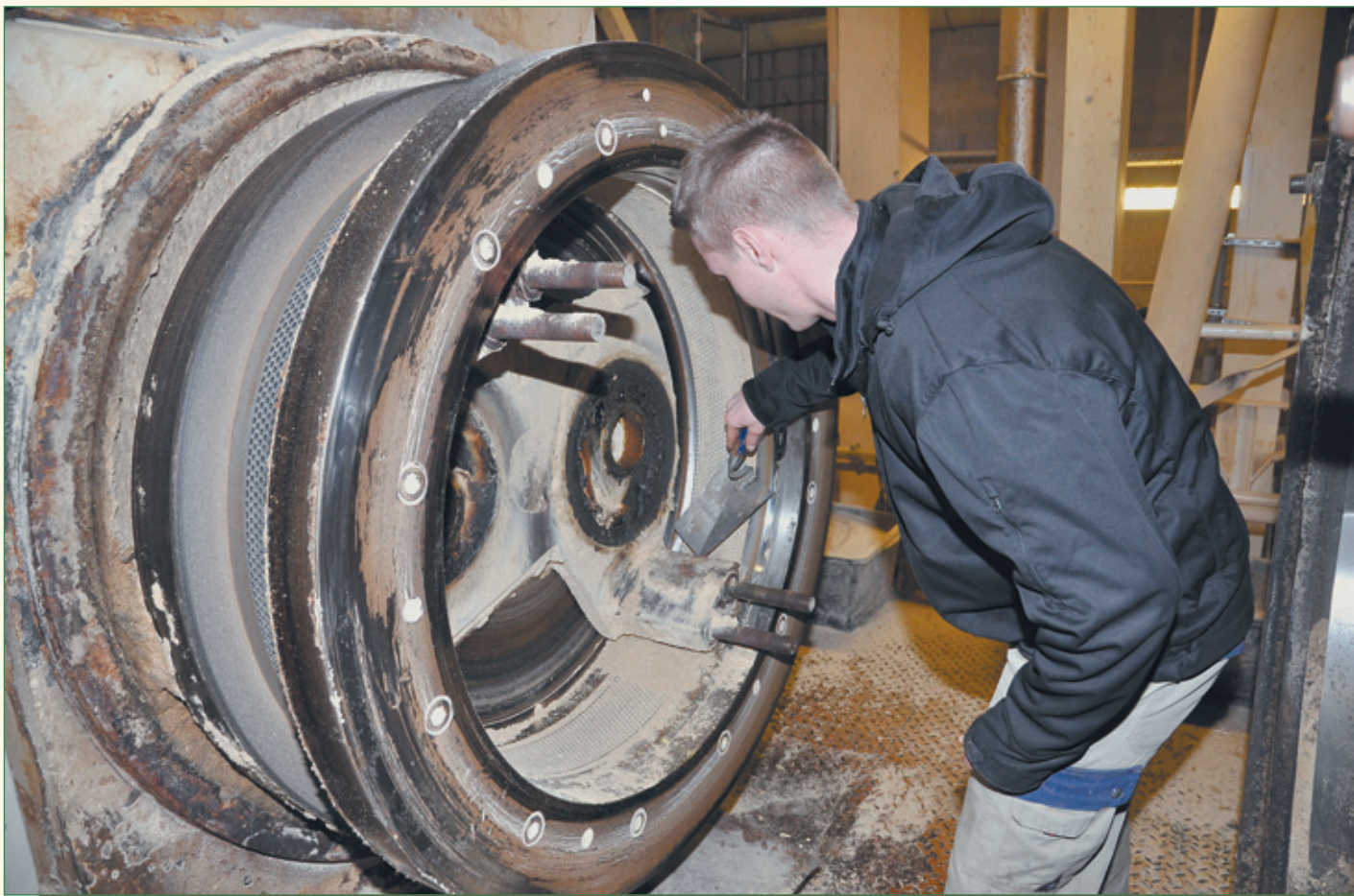
Wartung: Marvin Kempf ist stets zur Stelle, wenn ein Produktionsteil, wie diese für die Pelletherstellung essentielle Matrice, gereinigt oder repariert werden muss. Foto: Sommer
