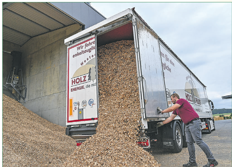
Abladen: Der Nebenantrieb, der den Schubboden bewegt, wird ebenfalls vom elektrischen Lkw versorgt.
