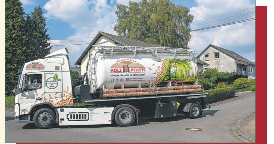
Wendigkeit: Doppelt bereifte, gelenkte Achse hinten: Damit ist der E-Lkw manövrierfähiger als manches „Solofahrzeug“ ohne Auflieger.
