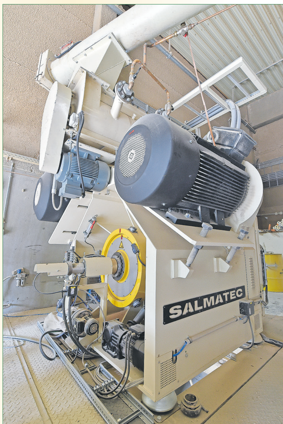
Presse: Die neue Maschine ermöglicht die Pelletherstellung mit nur noch 102 bis 104 kWh je Tonne.
