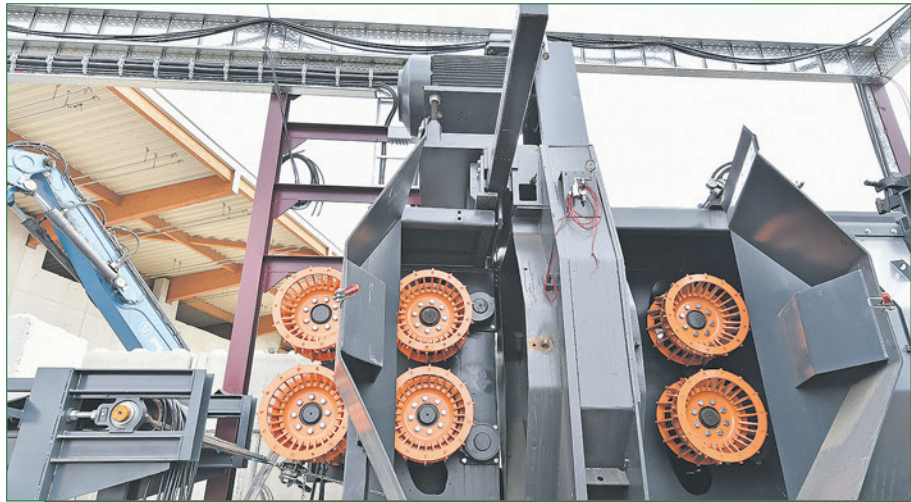
Bearbeitung: Zwischen diesen Rädern werden künftig die Stämme gefräst werden.
