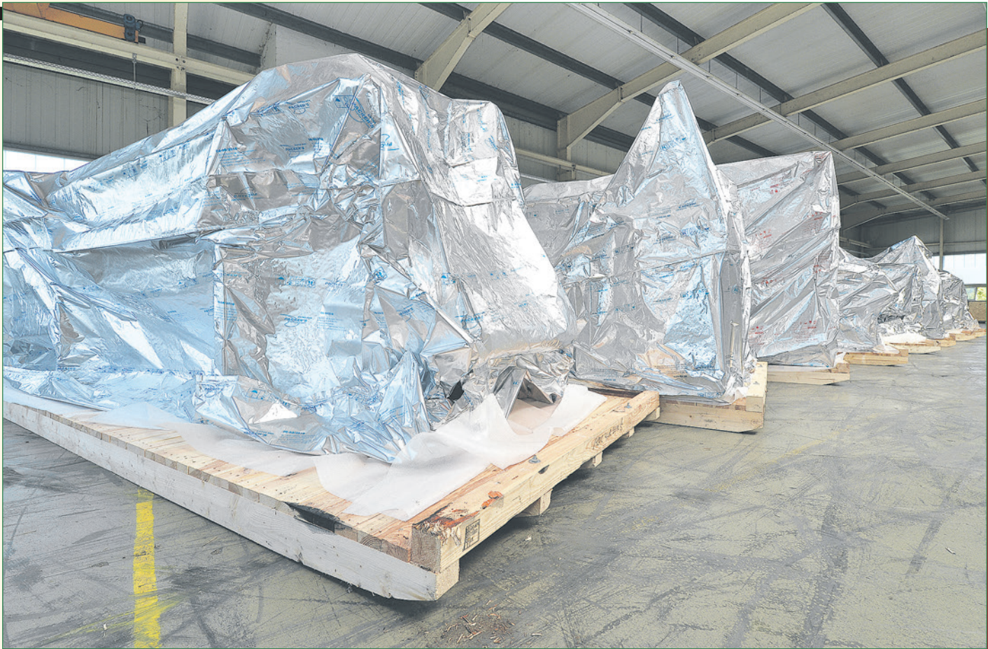
Schutz: Die Firma Lenz sorgt auch für die Güter schützende Materialien im Innern ihrer Holzkisten, so etwa durch feuchtigkeitshemmende und temperaturbeständige Folien.
