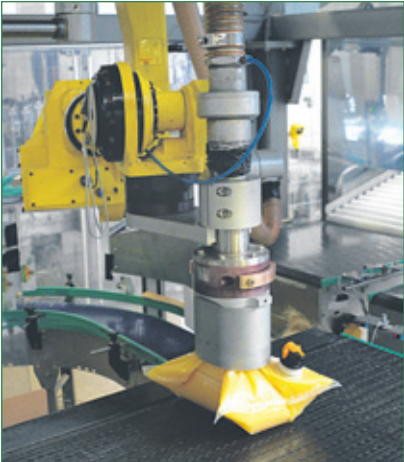
Bag: Bis zu 20 Liter Saft oder Konzentrat werden in Kunststoffbeutel gefüllt und damit in Kartons gesetzt.
